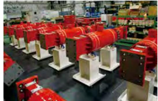
Viscous Damping System RDT Viskosedämpfer RDT
